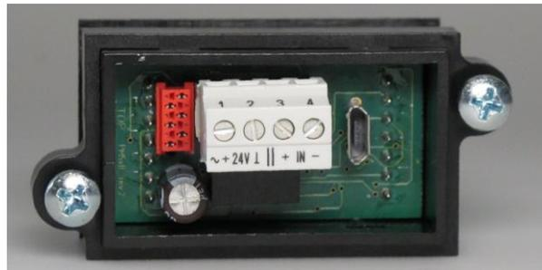
Befestigung X1:Versorg. Eing. X3:Micro-USB (Typ B)
