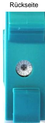
Drehschalter an der Geräte-Rückseite.
