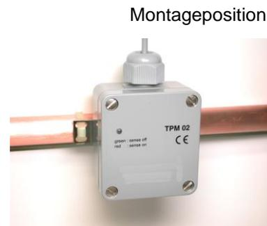
Der Taupunktmelder TPM01-A hat einen Ruhestrom-Relaisschaltkontakt, d.h. das Relais ist im Normalbetrieb angezogen. Es wird somit auch ein Stromversorgungsausfall, ein Kabelbruch und ein Gerätedefekt signalisiert. Die Schaltschwelle (Empfindlichkeit) kann intern an dem Poti eingestellt werden. Bei Auslieferung steht das Poti in Mittelstellung. Der Betrieb (LED grün) und der Alarm (LED rot) werden auf der Front angezeigt.
