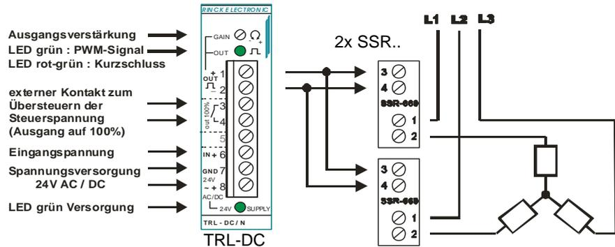
3.) Anschlussbeispiel: Drehstrom mit N-Anschluss
